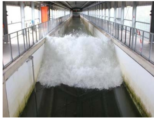
圖7 全德最大的斷面造波試驗水槽
