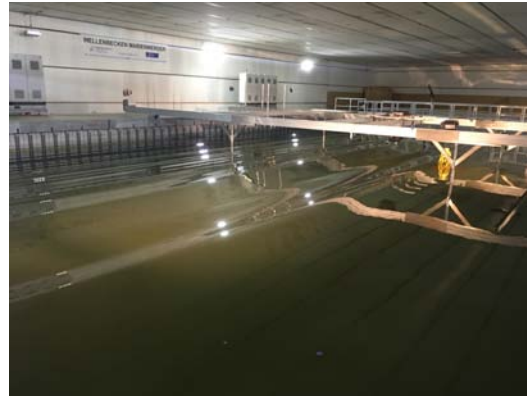
圖8 消波能力出色的二維造波水槽
