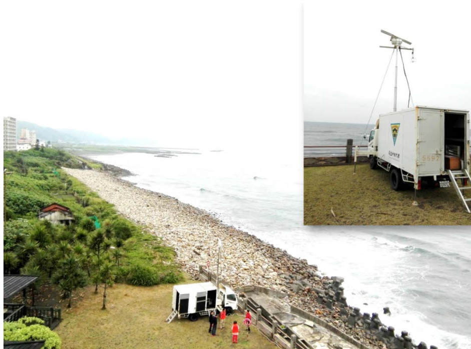
图 4 移动式岸基同调微波雷达架设运作情形
