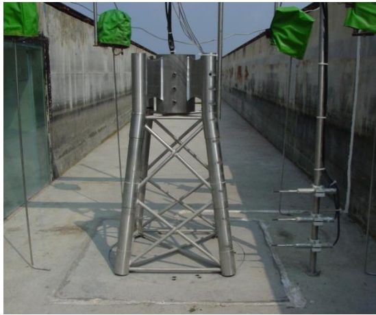
照片 1 基座柱体上压力计布置
